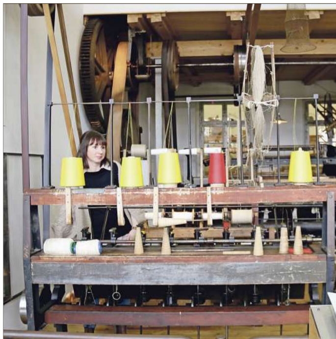
Dana-Livia Cohen zeigt an einer Spulmaschine, wie diese mit Hilfe von Lederriemen angetrieben wird.
